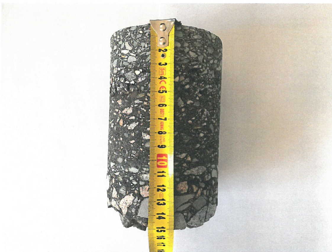
Obr. 4 – Konstrukce vozovky mostu přes Smržovský potok
